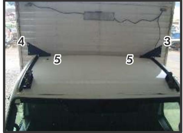
**4)** Fixar o teto sobre a cabine, e parafusar os suportes dianteiro no teto, utilizando 2 parafusos 6x25 fendas cruzada, 2 arruela lisa 6mm.
