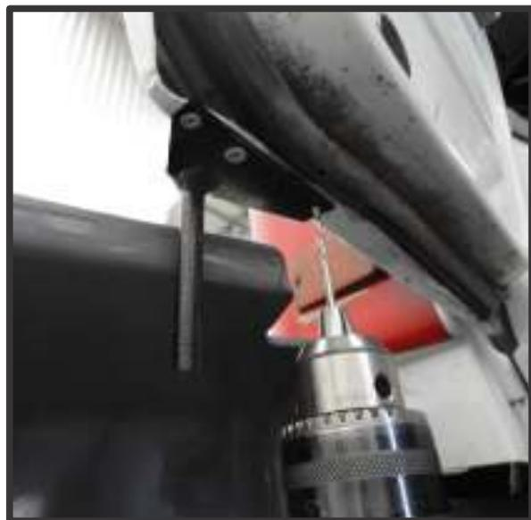
**4)** Encaixar o pino 3 por dentro do suporte da tampa. Realizar os mesmos passos para o outro lado. OBS: sempre que necessário bascular a cabine, deixe a tampa aberta e deve-se retirar o parafuso do suporte da tampa e retirar o pino 3 de dentro do suporte, para evitar que a mesma se quebre.
