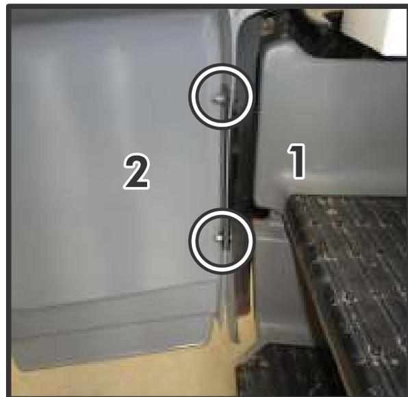
**3)** Posicionar o pino 3, no início da porta conforme mostra a foto, fazendo 3 furos com uma broca 2mm e fixar com 3 parafusos 3,5x16, repetir os mesmos passos para o outro lado.
