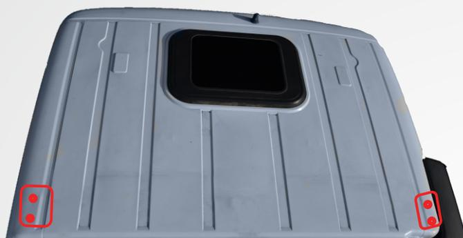
Localize no teto da cabine do caminhão os 4 pontos de furação (São 2 pontos em cada lado). Em seguida use uma furadeira com broca 7mm para expandir a lata.
