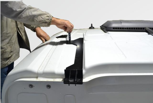
**1º passo** - Marcar os pontos de furação da cabine, para isso encoste o suporte n° 1 para LE e n°2 para LD nos frisos do caminhão conforme imagem 01.
