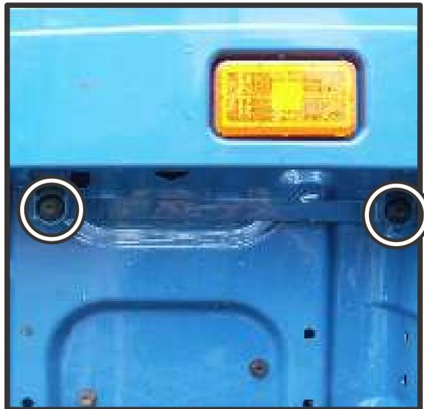
**2)** Retirar os parafusos da parte interna do estribo.
