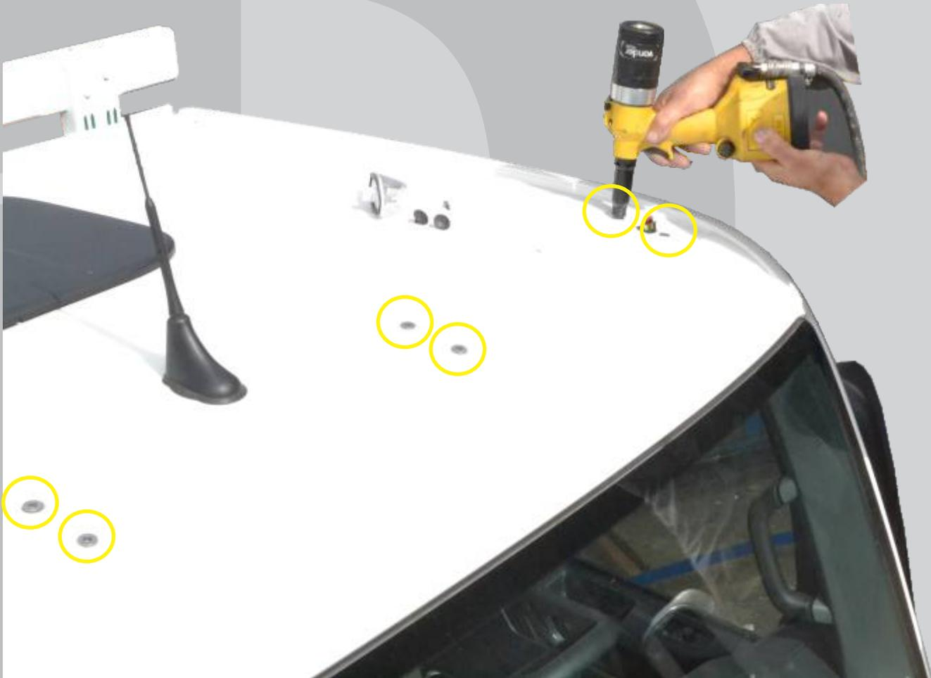
**Terceiro passo:** Vedar todos os pontos de fixação utilizando:
