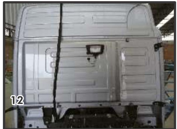
**3)** Para fixar o suporte nº9 e necessário colocar o reforço nº14 no friso da cabine, conforme mostra a foto, e após, fixar o suporte nº9, utilizando 2 parafusos 6x25 sextavado e 2 porca 6mm simples.
