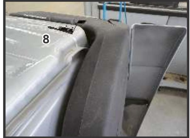
**8)** Colocar a borracha de vedação no teto, e após, posiciona-lo sobre a cabine fixando nos suportes n°7 lado esquerdo e n°8 lado direito, com 4 parafusos 6x25 fenda cruzada preta, 8 arruela lisa 6mm preta e 4 porca travante 6mm.
