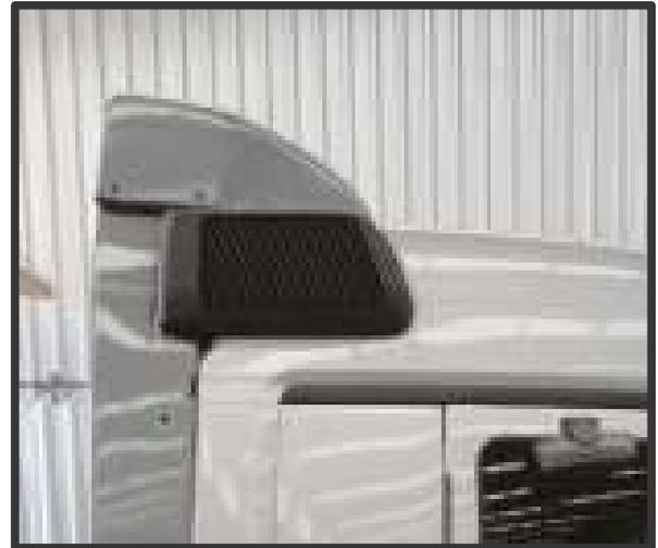
**9)** Fixar o suporte n°11 no teto e no grampo n°3 que esta na parte externa do teto, e o suporte n°6 no friso da cabine, utilizando 4 arruela lisa 8mm, 4 porca travante 8mm. Sendo os mesmos passos para o outro lado.
