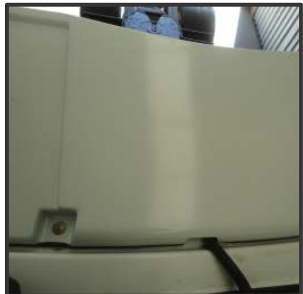
**9)** Após o teto fixado sobre a cabine, realizar a furação dos furos de fixação laterais do teto utilizando broca 8mm e fixar utilizando 2 parafusos 8x25mm fenda cruzada preta, 2 arruelas de chapeador e 2 porcas travantes 8mm. Repetir os mesmos passos para o outro lado.
