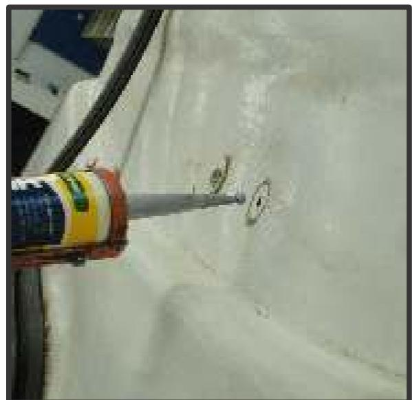
**7)** Preparar o teto para a montagem colocando a borracha de vedação e os parafusos nos lugares. Utilizar 2 parafusos 8x30mm, 2 arruelas de pressão 8mm, 2 arruelas de chapeador e 2 arruelas de borracha.
