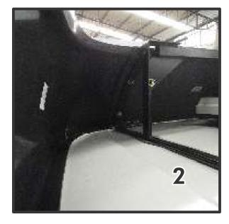
8) Posicionar e fixar as laterais inferiores e superiores junto ao suporte n°13 e 14 utilizando 4 parafusos sextavados 8x25mm, 4 arruelas lisas 8mm, 4 arruelas de chapeador 8mm e 4 porcas travantes.
