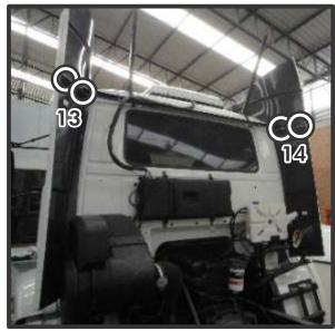
9) Bascular a cabine do caminhão para fixar o suporte n°19. É necessário desparafusar a trava de bascular para poder fixar o suporte n°19 (lado direito). Encaixar o suporte por baixo da trava e fixá-lo utilizando os parafusos originais. Fixar a lateral inferior na ponta do suporte n°19 utilizando 2 parafusos sextavados 8x25mm, 4 arruelas lisas 8mm e 2 porcas travantes 8mm.
