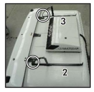
2) Posicionar o suporte nº1 em cima dos suportes nº2 e 3 utilizando 2 parafusos sextavados 8x25mm, 4 arruelas lisas e 2 porcas travantes 8mm.
