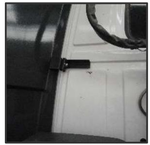
12) Fazer a montagem do centro do teto junto as laterais do teto utilizando os seguintes suportes: n°6 e 7 na ponta da frente e n°4 e 5 na parte de trás do teto. Na parte da frente (suportes n°6 e 7), utilizar 4 parafusos sextavados 8x35mm, 6 arruelas lisas 8mm, 2 arruelas de chapeador 8mm e 4 porcas travantes 8mm. Nas demais furações (incluindo suportes n°4 e 5), utilizar 12 parafusos sextavados 8x25mm, 8 arruelas lisas 8mm, 16 arruelas de chapeador 8mm e 12 porcas travantes 8mm.
